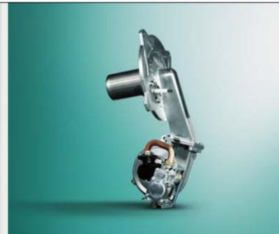
**Sistema electrónico de combustión aire-gas** que proporciona un amplio rango de modulación 1:6 para calefacción y hasta 1:7 para ACS, lo que asegura un consumo bajo de gas y de uno de los más altos grados de eficiencia y baja rumorosidad. No para VMW 236/5-5
